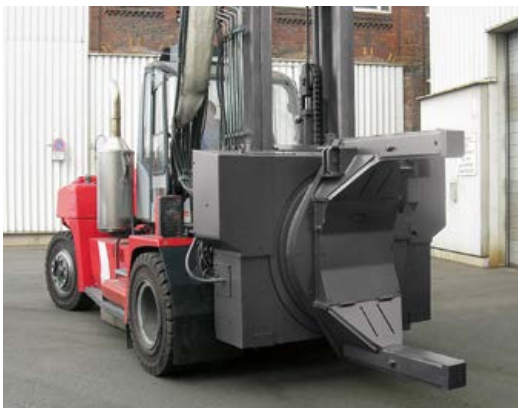
DREHGERÄT MIT VOLLSCHUTZ UND KONVERTERAUFNAHME
