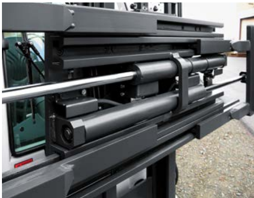
SCHUTZBLECHE VOR DEN HYDRAULIKANSCHLÜSSEN DER ZYLINDER (OPTIONAL)
