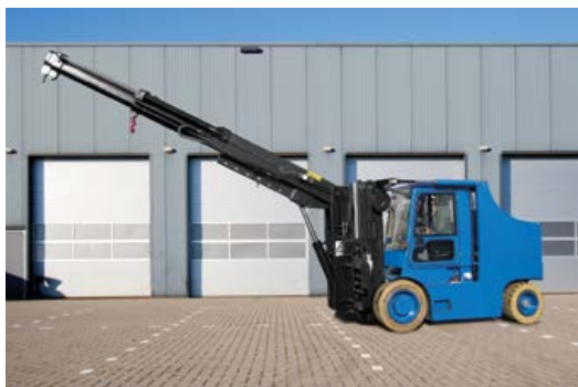
KRANARM, TELESKOPIER- UND NEIGBAR
