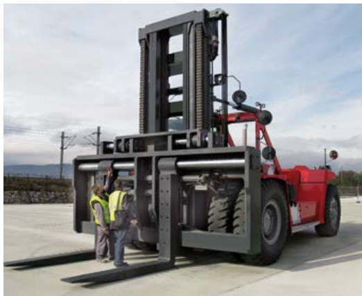
ZINKENVERSTELLUNG - TRAGFÄHIGKEIT 55.000 KG / 1200 MM
