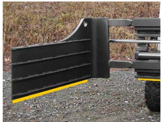
VERSCHLEISSLEISTEN UNTER KLAMMERKÖRPER UND ARMEN (OPTIONAL)
