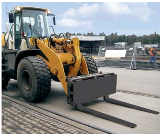
ZINKENVERSTELLUNG MIT SONDERSCHUTZ FÜR RADLADER
