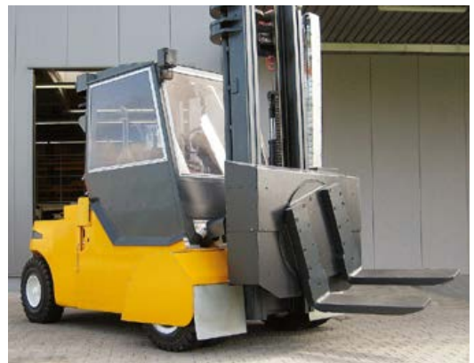
S 8-DE 80 MIT SEITENSCHUB UND WIEGESYSTEM
