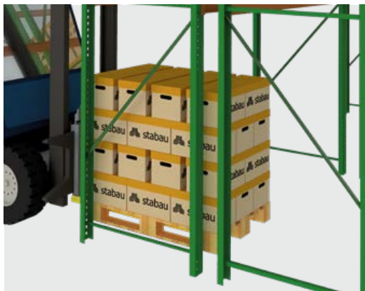
DOPPELTIEFE EINLAGERUNG EINGEFAHREN
